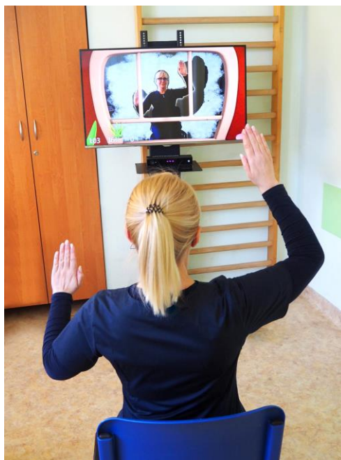
Rycina 2. System komputerowej rehabilitacji z biofeedbackiem ( SeeMe ), zadanie „Cleaner” – symulacja czyszczenia okna wykonywana w pozycji siedzącej, obustronne, asymetryczne ruchy kończyn górnych, możliwość zaplanowania zakresu aktywności ruchowej (obszaru brudnej szyby), lustrzane odbicie postaci użytkownika.
